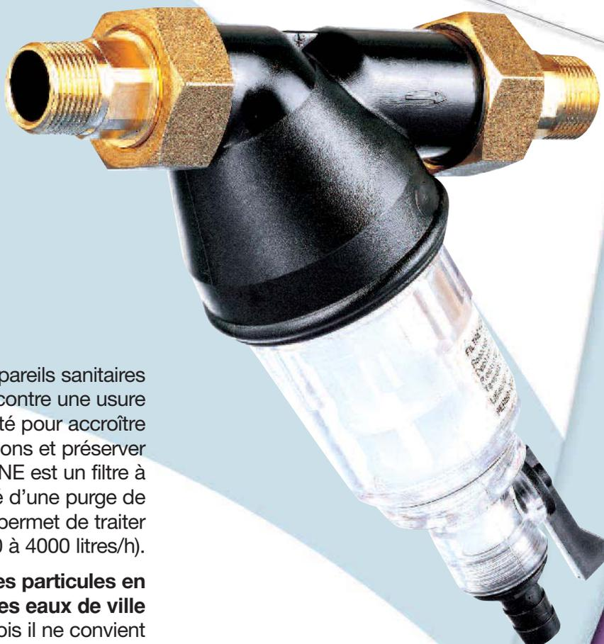
**Protéger** l'ensemble des appareils sanitaires et électroménagers contre une usure prématurée, est une nécessité pour accroître la durée de vie des installations et préserver leur aspect. Le PERMOFINE est un filtre à tamis 100 microns, équipé d'une purge de décolmatage manuelle qui permet de traiter des débits élevés (3000 à 4000 litres/h).
